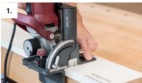
1. P-System Nuten fräsen, 20 mm versetzen mit dem Winkelanschlag
