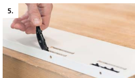
5. Clamex P Verbinder einschieben
