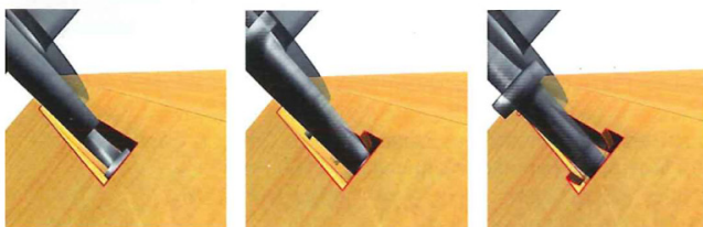
Beim Fräsvorgang taucht der Fräser zunächst bis zur endgültigen Tiefe ein. Anschließend erfolgt eine kurze Auf- und Ab-Bewegung für die Profilnut
