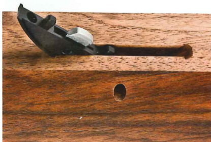
Beim Fräsvorgang taucht der Fräser zunächst bis zur endgültigen Tiefe ein. Anschließend erfolgt eine kurze Auf- und Ab-Bewegung für die Profilnut
