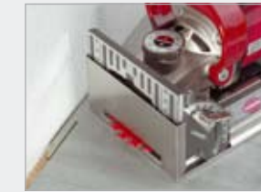
Schattenfugen (Kreissägeblatt Art. Nr. 132380 und Gleitschuh Art. Nr. 251057)
