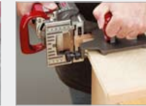
Para recorte de resaltes (Máquina recortadora Lamello Nova Art. No. 121280)
