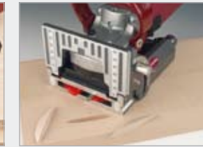
Para parchado de los defectos de la madera (Fresa Minispot Art. No. 132217)
