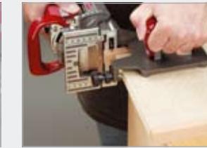
Per intestare bordi sporgenti (Accessorio per il taglio del bordo Lamello Nova Art. No. 121280)
