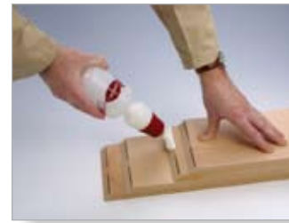
2. Spargere la colla nella fresata
