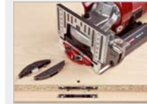
Clamex - La giunzione Lamello (Fresa di 8 mm Art. No. 132108)
