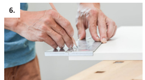
6. Verbindermittle auf dem Fachboden markieren
