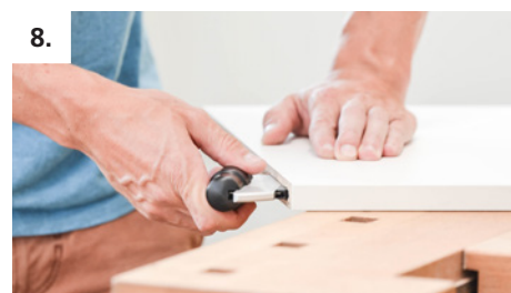
8. Divario P-18 in die Seiten und den Fachboden einbauen
