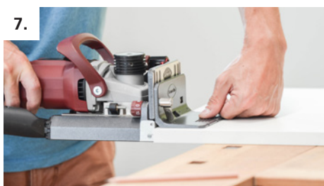
7. Fräsungen der Längs- sowie P-System Nuten im Fachboden vornehmen
