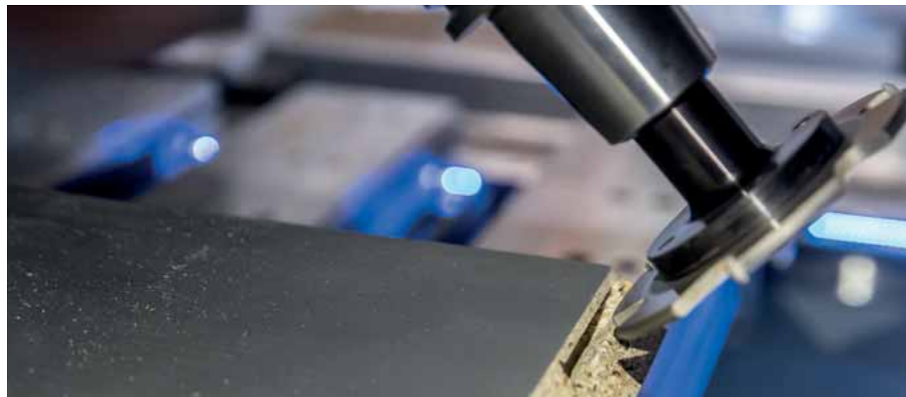
P-System Profilnut Fräsung mit der Homag Venture 316 L CNC 5-Achs
